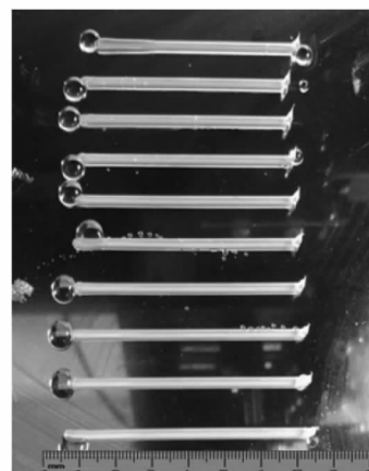
(a) 打印完成的同轴硅橡胶管道
